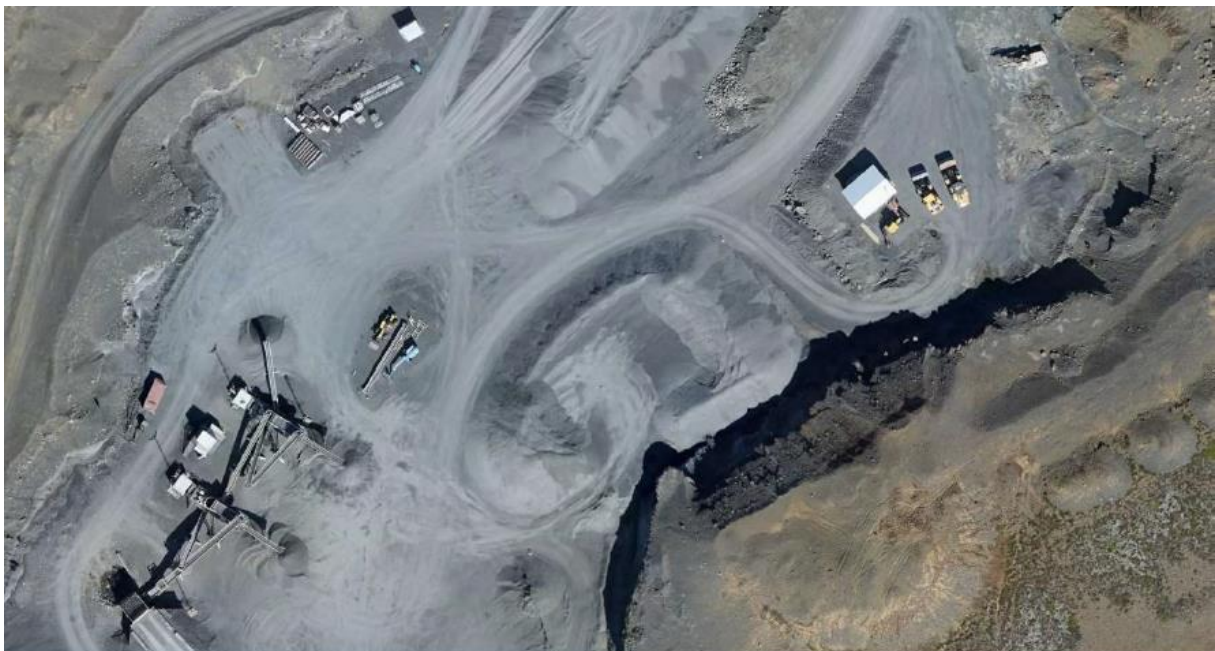
MYND 5. Yfirlitsmynd af vinnslusvæði ÍAV í Rauðamel. Aðstaða starfsmanna er hvíti skúrin til hægri á myndinni. Brjóturinn á myndinni gengur fyrir rafmagni, ekki olíu.
