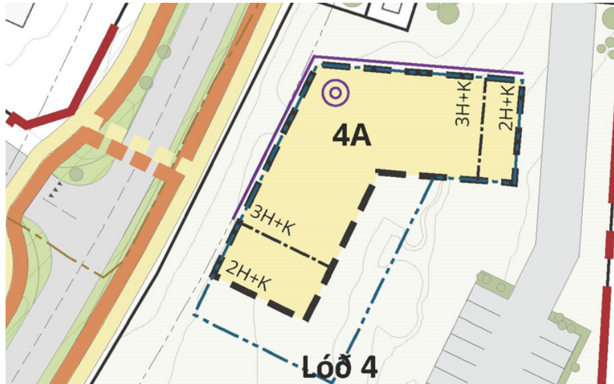
Mynd **: Lóð 4, reitur 4A. Dæmi um horn sem er talið vera mikilvægt fyrir heildarásýnd svæðisins og götumynd Grænásbrautar. Hornið er áberandi við innkomuna inn á Ásbrú og blasir við þegar horft er eftir Bogabraut.
