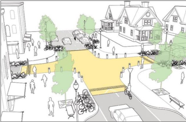
MYND 5 Dæmi um upphækkuð gatnamót. Allir leggir gatnamótanna eru hækkaðir upp og byrjar allt að 10 m fyrir gatnamótin sjálf (Mynd frá NACTO, 2021).
