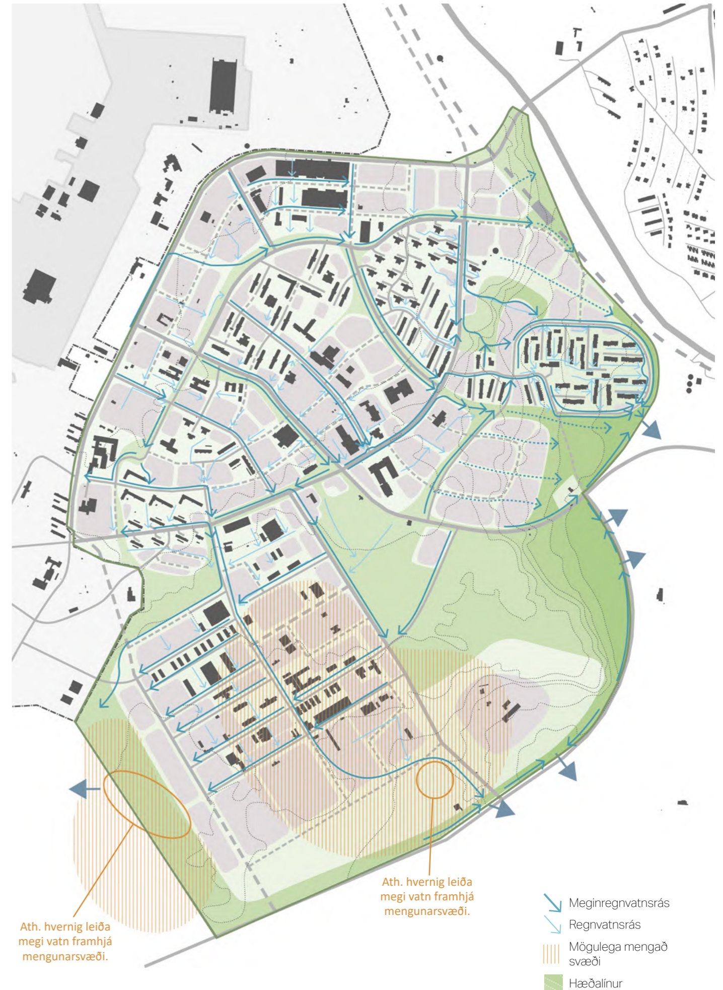
Einfaldað kort úr skýrslu COWI sem sýnir megin rennislísið, sjá nánar í fylgiskýrslu.
