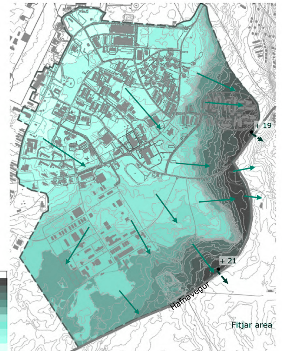
Kort sem sýnir landhalla á Ásbrúarsvæðinu og megináttir þangað sem ofanvatn rennur. Kort úr skýrslu COWI um blágrænar ofanvatnsluasnir á Ásbrú.
