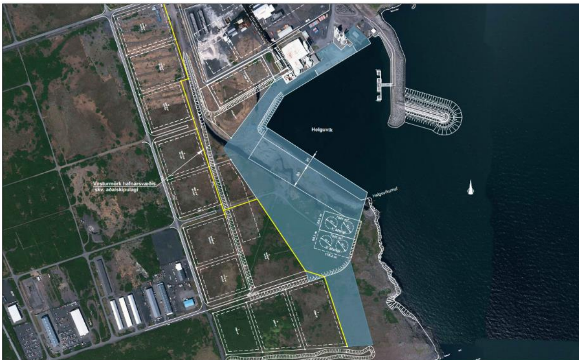
Mynd 8 Fyrirhugað framkvæmdasvæði í og við Helgúvíkurhöfn samkvæmt uppdrætti Verkfræðistofu Suðurnesja, þ.e. viðlegukantur, landfylling, brimvörn og svæði þar sem fyrirhugað er að fram fari efnistaka og uppbygging olíubirgðastöðvar.
